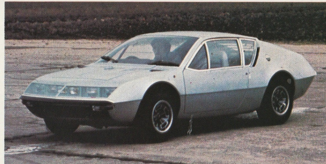
Alpine A 310 4 Zylinder Reihenmot. Renault 1,6 l 1,565 Liter 125 PS (DIN), 138 PS (SAE), 92 kW
